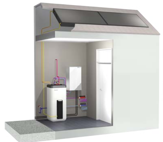
Jednostka naścienna połączona ze zbiornikiem akumulacyjnym ECH 2 O i kolektorami słonecznymi
